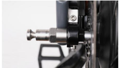
Nei modelli di Pedelec con cambio al mozzo non è necessario sostituire l'intero perno per poter usare il rimorchio Croozer. È sufficiente sostituire il dado sul lato sinistro del perno.
