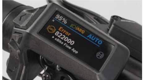
Se il LED non si accende all'accensione del sistema di propulsione o non si spegne al raggiungimento di 5 km/h, oppure se rimane sempre acceso durante la marcia, è presente un errore dell'ABS.
