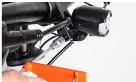
Dopo aver regolato la posizione giusta, serra la vite di fissaggio del fanale a 3 Nm.
