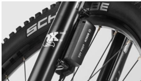
Alcuni modelli, ad es. Pathlite:ON SUV e Grand Canyon:ON, sono dotati del sistema ABS (Anti-lock Braking System) di Bosch.
