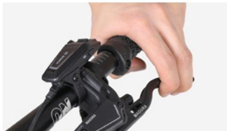
L'ABS si attiva automaticamente non appena azioni i freni. È importante che utilizzi i freni come sei abituato. Non preoccuparti se il freno o la leva del freno vibrano leggermente, in particolare durante la fase di frenata. Il sistema ABS si attiva solo se continui a tenere tirata la leva del freno.
