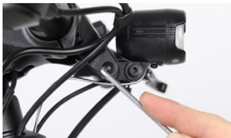
Utilizzando una chiave a brugola da 3 mm, svita la vite di fissaggio del fanale quanto basta per poter alzare e abbassare il fanale con la mano nel supporto.
