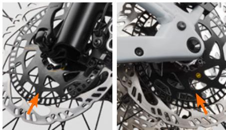
Sulle ruote anteriore e posteriore sono montati dei sensori che verificano continuamente la velocità.
