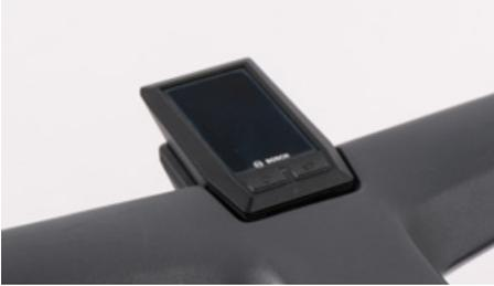
Alcuni modelli con motore Bosch sono dotati di display KIOX. Questo display è tenuto fermo da magneti.
